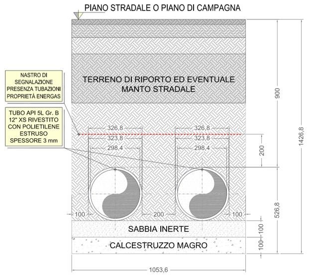
**PARTICOLARE 2: SEZIONE TIPICA POSA SOTTOMARINA GASDOTTO (SEA LINE)- SCALA 1:10**
