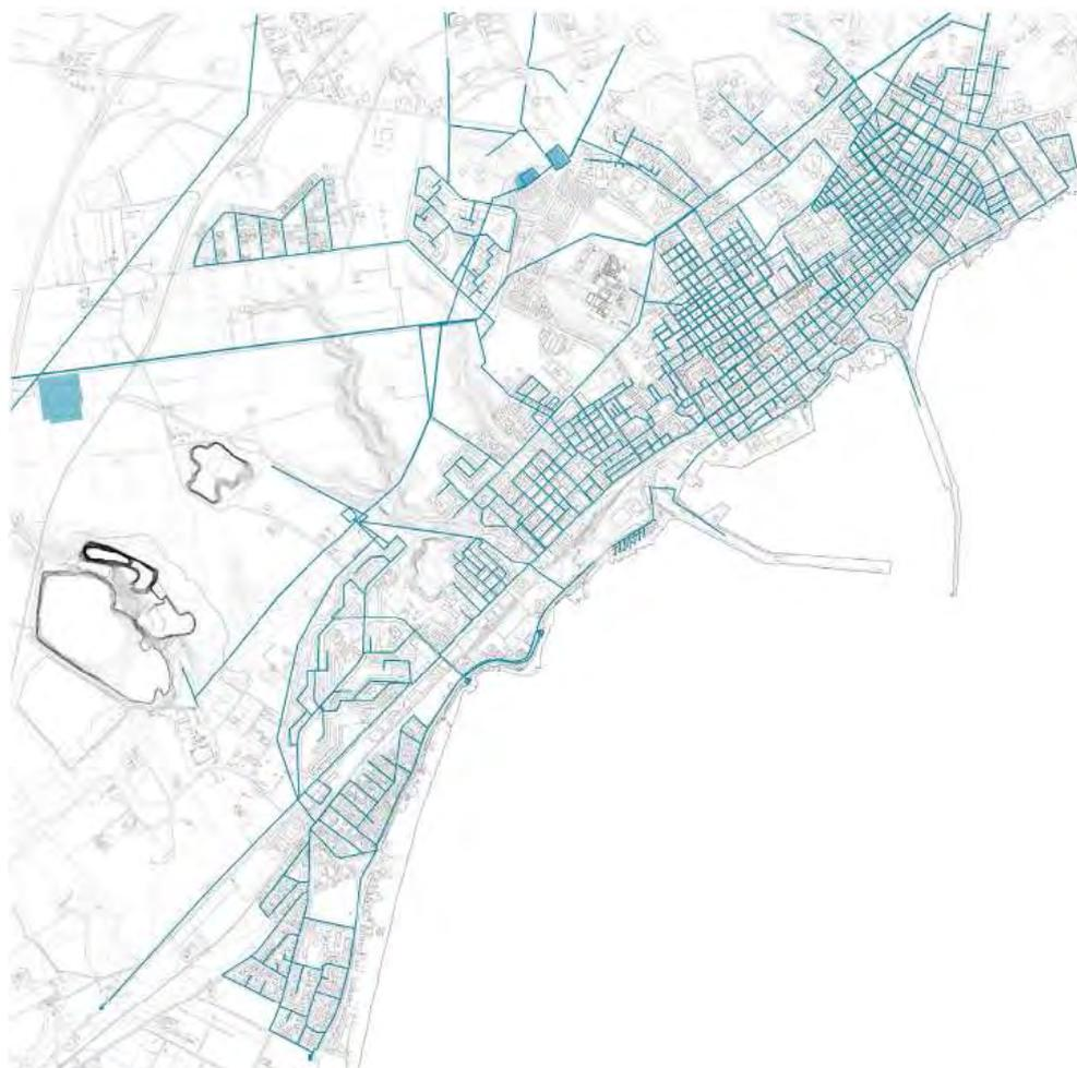
**A.14. INTERVENTI DI MANUTENZIONE ORDINARIA / ANNO** Ogni anno si effettuano circa 100 interventi di manutenzione sulle condotte di distribuzione interna per risolvere perdite e malfunzionamenti imputabili o alla fatiscenza delle vecchie condotte o a locali assestamenti delle tubazioni in ghisa che occasionalmente possono interessare anche il nuovo.
